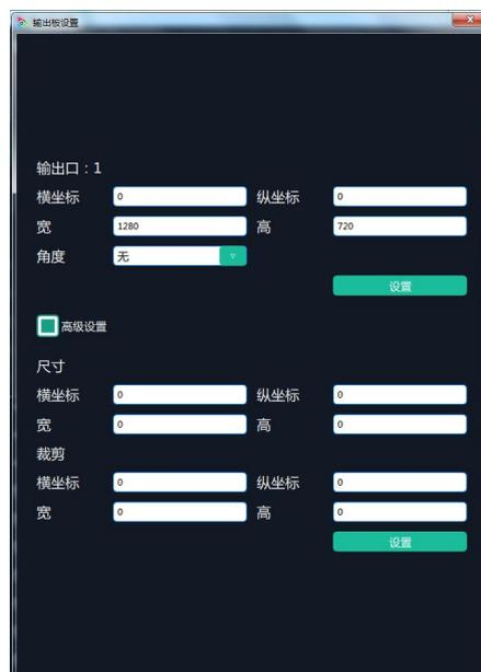
若需要连接大屏，或拼接位置的图像有偏差时，需要调整高级设置的参数。在高级设置中，用户可对输出板的尺寸进行调整并进行裁剪。
