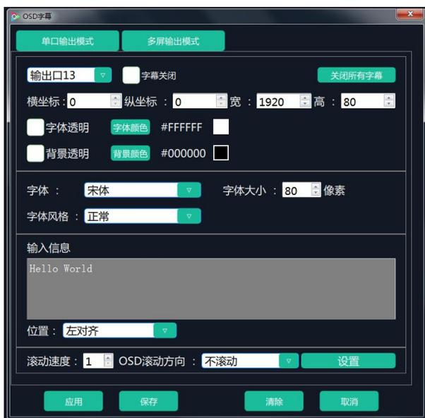
**输出模式:** 用户可以选择单口输出模式或者多屏输出模式。单口输出模式和多屏输出模式基本相同。不同的是, 在单口输出模式中, 用户需要先开启字幕功能, 再选择输出口。
