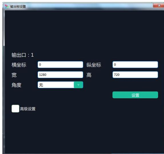
用户可以对输出板进行位置、尺寸及角度调整等操作，设置完成后，点击“**设置**”进行确认。若点击“高级设置”，弹出窗口如下：
