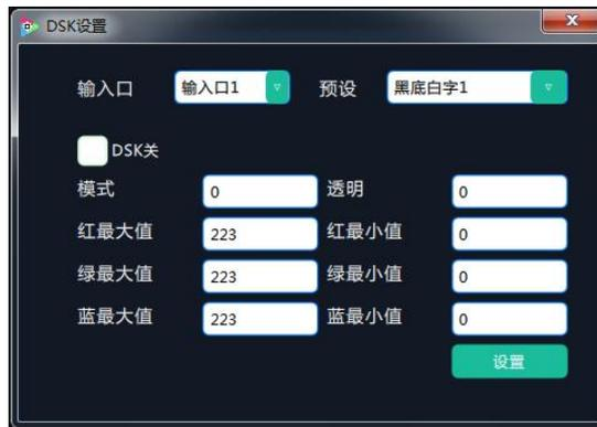
在 DSK 设置中，用户需要在 DSK 开关中打开 DSK 功能，如图：
