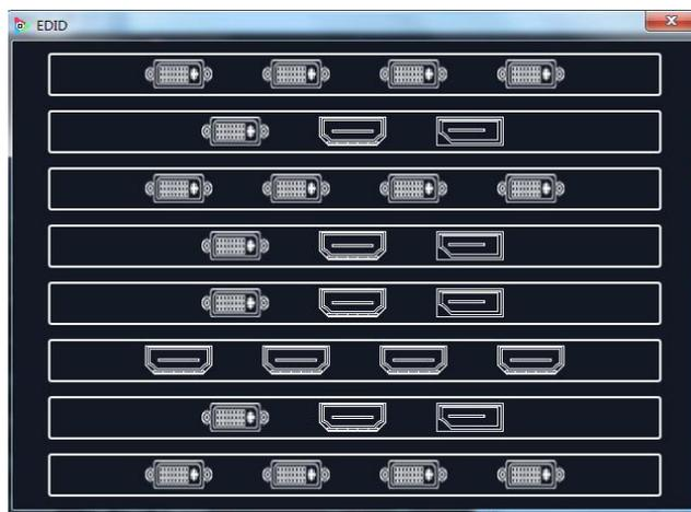
此处为 EDID 信息更改，用于自定义非常规分辨率输出。用户可选择输入板或者输出板，点击任意接口，进行 EDID 读、写及模板设置，设置完成后，点击“设置”进行确认，如下图所示：
