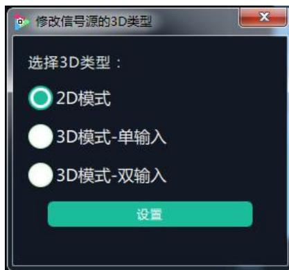
用户可以选择“3D 模式-单输入”或“3D 模式-双输入”，选择“3D 模式-单输入”时，信号源接口上就会显示“3D”字样，如下图所示：
