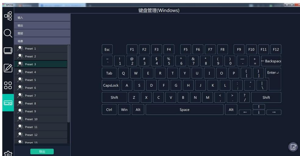
将常用的输入、输出、图册和场景逐一拖入键盘的按键上如下图。
