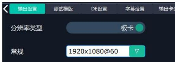
2.1.1 输出设置：含有分辨率类型，可选板卡或者全局；选择板卡，只能选择常规分辨率，常规分辨率有 47 种可选，最高 4096x2160@60 ;选择全局，可以进行自定义分辨率设置。
