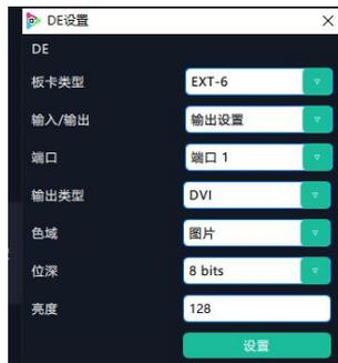
板卡类型：EXT4（EXT 4F-OM 矩阵输出转接板和 EXT 4F-IM 矩阵输入转接板）和 EXT6（EXT 4F-OS 拼接输出转接板），用户根据设备的实际安装选择对应的 EXT4 或者 EXT6。
