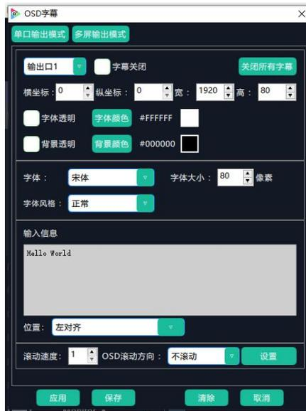
输出口 1-4，一张 EXT6 可接 4 个输出口,但只有第一个输出口能支持 OSD 显示，例如输出口 1-4 都是接到同一个 EXT6 上，只有输出口 1 支持 OSD 显示。
