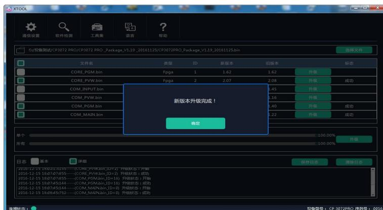
c. 升级完成后,需重启设备,再进行软件检测,否则 CORE\_PGM 和 CORE\_PVW 旧软体版本会识别错误。
