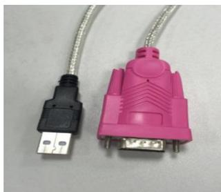
1. 在电脑桌面的计算机【管理】中，查看端口的串口号；然后在 XTOOL 工具软件里将串口改成相应的串口号。
