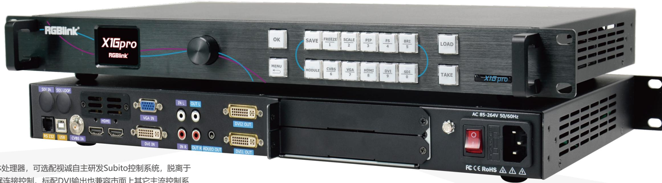
X1Gpro是一款2K级LED屏显示控制一体处理器，可选配视诚自主研发Subito控制系统，脱离于电脑通过本地操作就可以实现LED显示屏连接控制。标配DVI输出也兼容市面上其它主流控制系统带载，满足现场不同控制系统的LED显示屏控制。输入X1G提供1路任意输入模块和1路SDI模块选配，满足不同工程项目需求。在一些市政工程固定安装项目中X1Gpro提供一对音频输入，可实现音视频同步切换显示。
