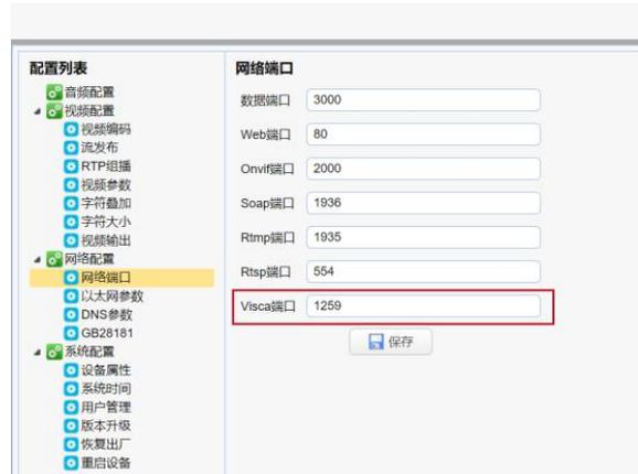
2.打开 mini+ 的控制软件 XPOSE mini, 点击 M 键→更多→PTZ 摄像头→设置→端口号，将旧 IP 与新 IP 都设置为您所要控制的摄像头的 IP，如 192.168.1.88，端口号为 1259。
