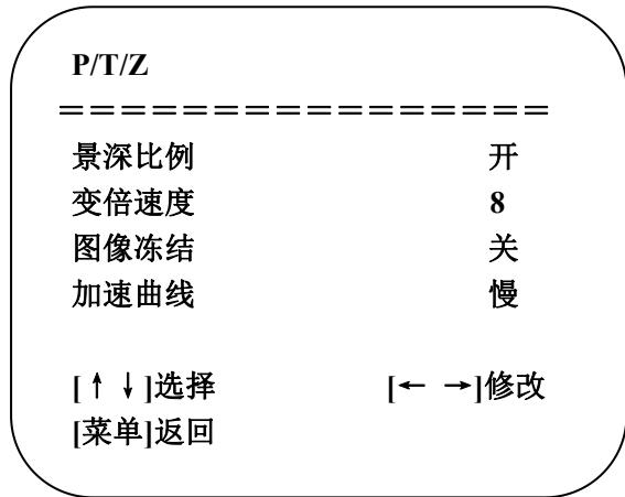
**景深比例:** 只对遥控器起作用, 开、关; 相机变倍拉大后, 遥控器控制云台转动速度变慢
