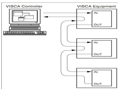
设备级联方式连接方法
