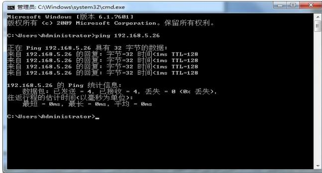
产品上电自检完成后，也可按照以上步骤验证网络是否连接正常。如默认 IP 打开计算机 DOS 命令窗口输入 ping 192.168.5.163 按下回车键出现信息如下图所示：说明网络连接正常。
