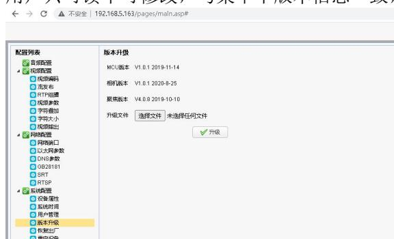
**升级文件:** 点击“选择文件”在弹出的窗口中，选择升级文件；点击“升级”按钮，弹出升级对话框；升级成功后，设备自动重启（注：升级过程中确保设备的电源和网络正常连接，否则升级失败）
