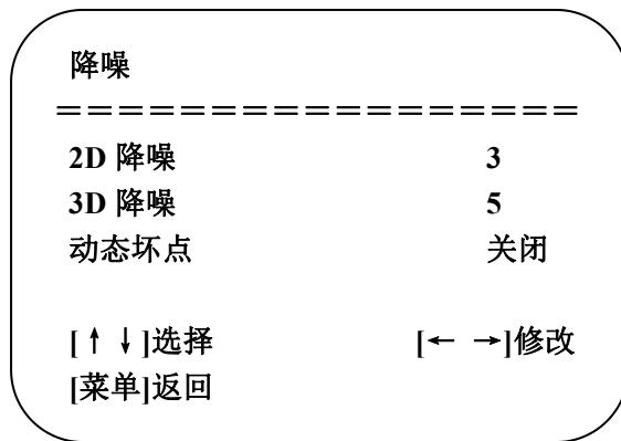
**2D 降噪**: 可设置项: 自动、关闭、1~7    **3D 降噪**: 可设置项: 关闭、1~8    **动态坏点**: 可设置项: 关闭、1~5
