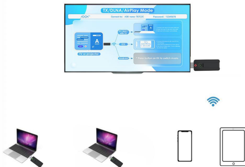
图为 ASK nano 的系统连接简图
