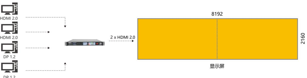
示例：4K输入切换为8Kx2K显示，使用两个输出，实现全景或宽屏显示
