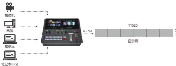
例：使用6路输出实现12Kx1K显示拼接
