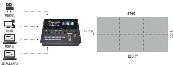
例：使用6路输出实现6Kx2K显示拼接
