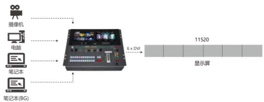
例：使用6路输出实现12Kx1K显示拼接
