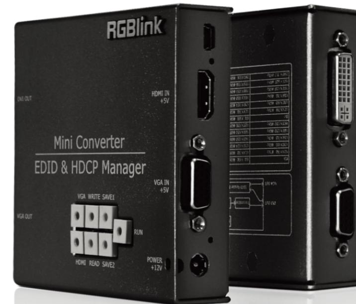
在现在一个数字信号的时代, MSP 221这款用于DVI, VGA 和HDMI信号源的EDID&HDCP管理器应运而生, 其按照用户选择的分辨率和刷新率, 将预先存储的EDID信息传送到信号源。或者也可以将MSP 221设置为在连接至显示设备时捕获并储存EDID信息。
