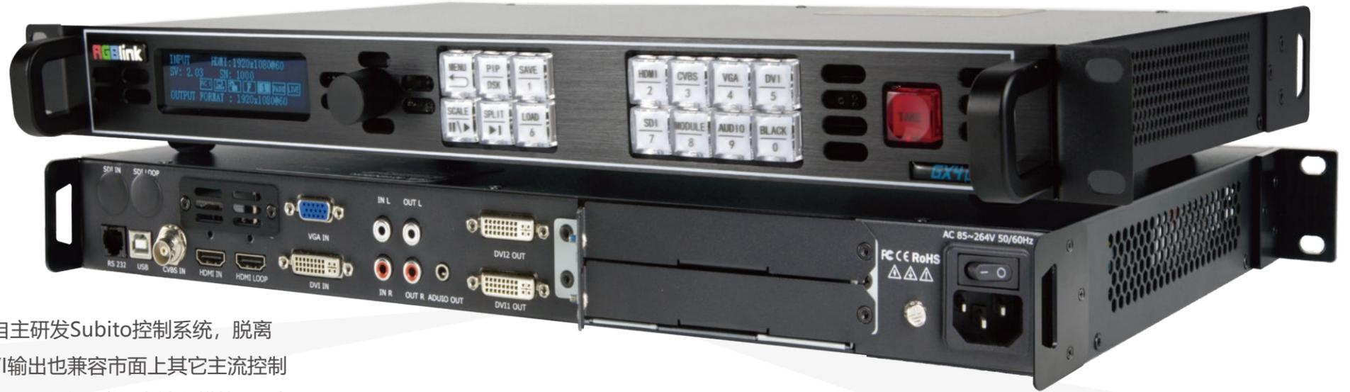
GX4pro是一款2K级LED屏显示控制一体处理器，可选配视诚自主研发Subito控制系统，脱离于电脑通过本地操作就可以实现LED显示屏连接控制。标配DVI输出也兼容市面上其它主流控制系统带载，满足现场不同控制系统的LED显示屏控制。输入GX4pro提供1路任意输入模块和1路SDI模块选配，满足不同工程项目需求。在一些市政工程固定安装项目中GX4pro提供一对音频输入，可实现音视频同步切换显示。
