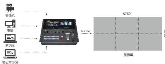
例：使用6路输出实现6Kx2K显示拼接
