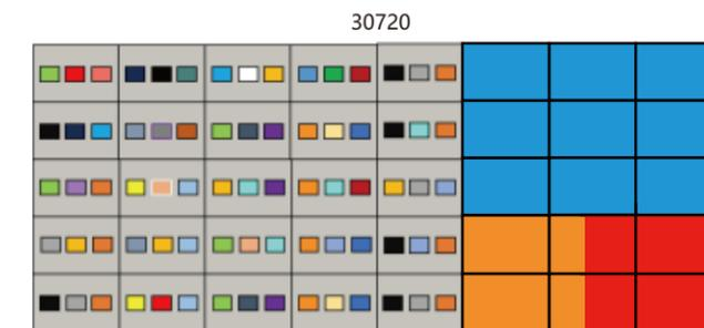
每个2K输出口最多8个图层，可根据指令将预设场景无缝切换出来，专门的PVW模块用于任意信号预览
