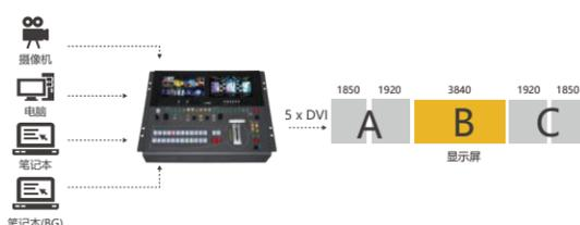
例：五个显示屏，中间带“B”显示屏使用主HDMI输出及窗口/图层。
