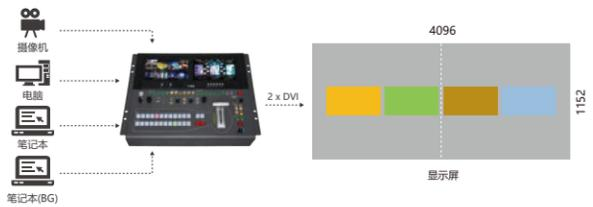
例：每路HDMI输出可支持两个视频切换图层
