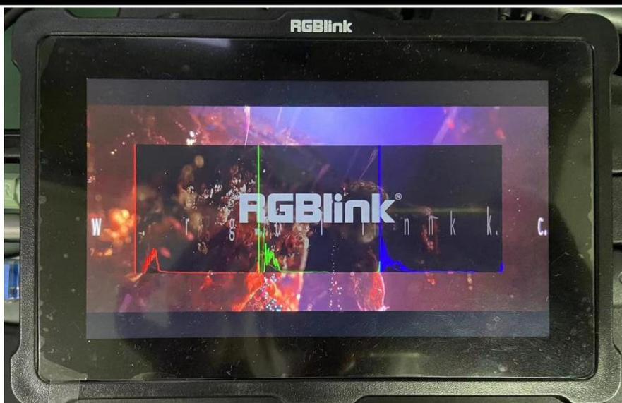
您首选需要打开直方图并选择显示尺寸。直方图的最左侧代表黑色，即画面中最暗的部分；最右侧代表白色，即画面中最亮的部分。在上图中，直方图分量主要集中于最左侧，即表示该画面较暗。由此，我们可以通过直方图来调整画面的曝光。
