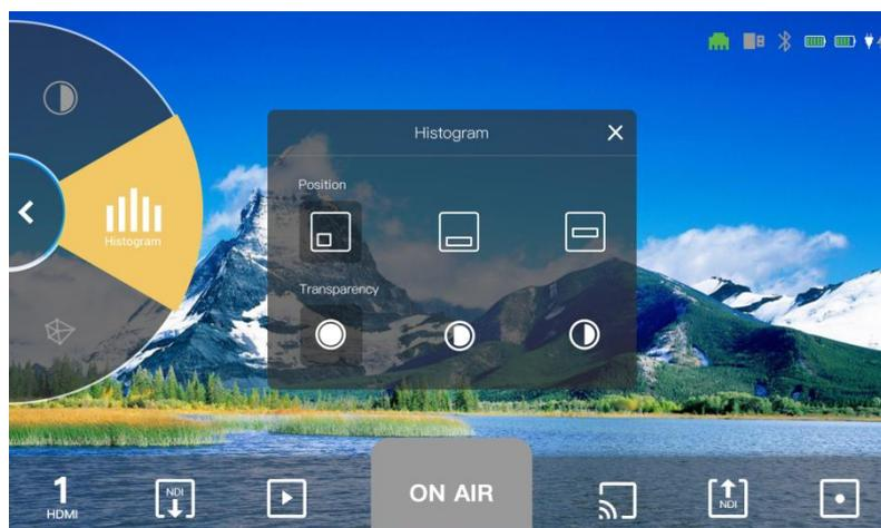
在直方图中，您可以设置显示大小和透明度。直方图用于查看动态范围，通过直方图，您可以清楚的看到图像的亮度状态，亮度直方图分为 R G B 三分量，当您使用相机的 Log 模式来拍摄对比度的图像时，可以完美地监看画面的明亮以此来获得正确的曝光。
