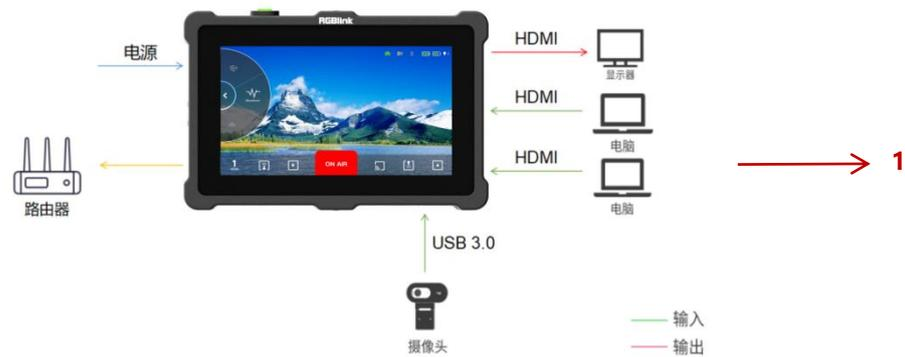
步骤 1: 您可以参考以上连线示意图连接 TAO 1pro 并通过查看 IP 地址确认设备是否已接入网络;
