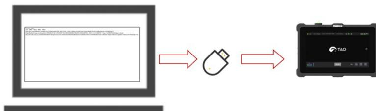
步骤 3: 在电脑上新建一个 TXT 文件, 将推流地址和串流密钥复制粘贴进去, 拷贝进 U 盘并保存成 rtmp.ini 格式。并将 U 盘插入 TAO 1pro: (推流地址格式为: rtmp: //推流地址/密钥。若您选择 YouTube 进行推流, 则推流地址与密钥之间需添加 “/” )
