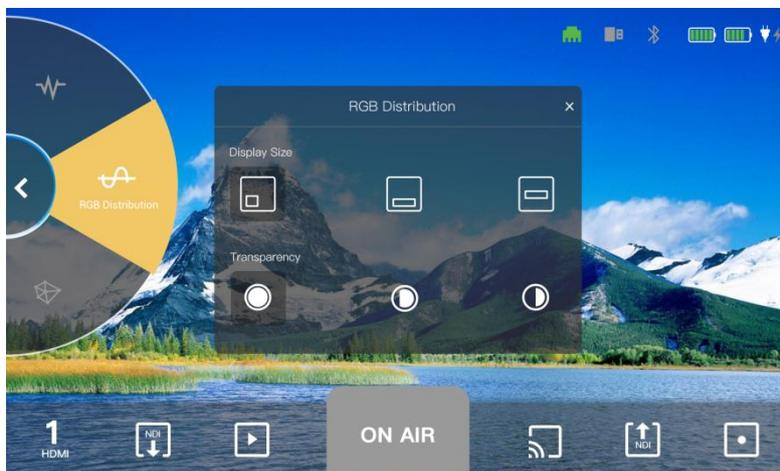
RGB 波形图用于检测白平衡，将摄影机对准白色物体，如果摄影机的白平衡设置正确，则红、绿、蓝三通道的波形水平应该一致。在 RGB 波形图中，您可以选择显示大小以及透明度。
