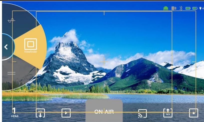
您可以根据所需的视频框架选择开启安全框，两个安全框的比例分别为 16:9 和 4:3, 方便您根据实际所需要的尺寸将安全框外的画面裁剪掉，如下图所示：
