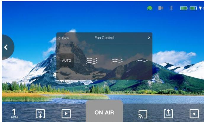
在风扇控制界面，您可以设置风扇的转速。风扇转速有三档可选，您也可以选择打开[Auto]以开启对风扇转速的自动调整。
