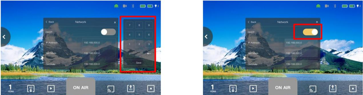
如您选择手动设置 IP 地址、子网掩码和网关，请先关闭[DHCP]模式，在设置完毕后，点击[Save]进行保存。
