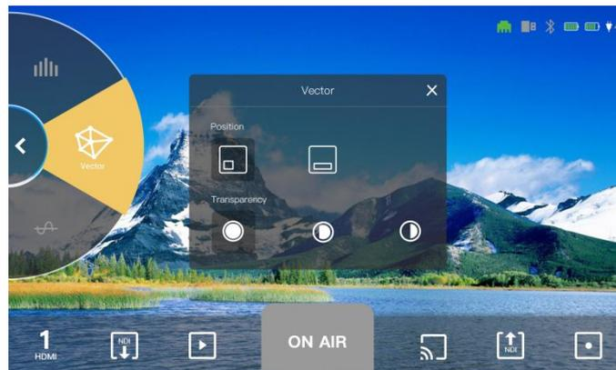
矢量图用以显示色相、向量、色彩强度的真实颜色信息（以矢量阶段显示）。在矢量图中，您可以设置显示大小和透明度。打开矢量图，您可以通过矢量图识别低饱和度区域以及决定拍摄时是否需要色彩平衡。
