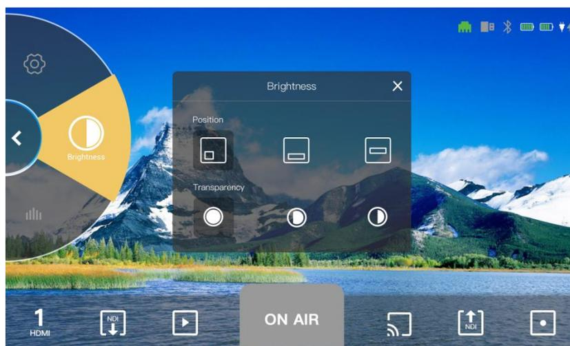
在亮度波形图设置界面，您可以调整波形图显示的大小以及透明度。
