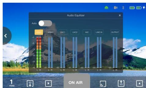
您可以看到 6 条音柱，从左至右分别是 2 路 HDMI 2.0 输入信号的音频，2 路 UVC 输入信号的音频，1 路 3.5mm 模拟音频输入，1 路 3.5mm 模拟音频输出，每一条音柱分为左右声道。当有多路输入信号时，您可以选择打开 [Auto] 自动跟随模式或通过音柱上方的按钮选择您要开启的音柱。黄色为选中状态。
