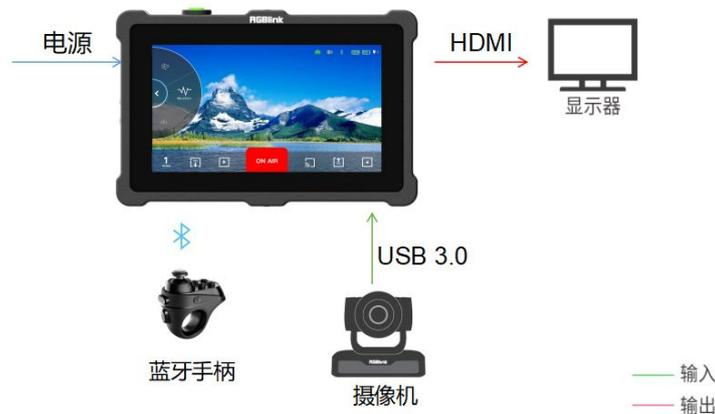
点击[Bluetooth]进入蓝牙设置页面，打开蓝牙，连接相应的蓝牙遥控设备，即可控制 PTZ 摄像头。
