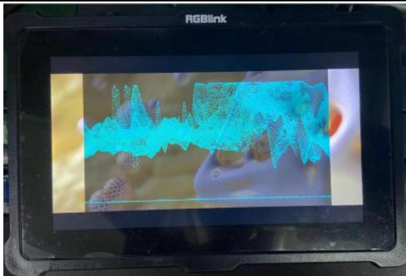
亮度波形图顶部代表最亮，底部代表最暗。如上图所示，波形主要集中于顶部，且分布于右侧，则表示画面右侧部分较亮，底部较暗，因此您可以通过亮度波形图，针对亮度不足的区域，进行针对性补光。
