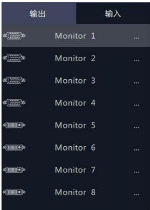
输出口列表显示当前连接的输出板卡类型和输出口的数量。
