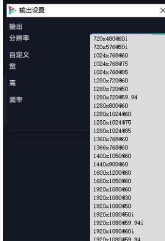
注：拼接模式输出分辨率不支持 720×480i@60Hz、720×576i@50Hz、2560×816@60、2048×1152@60
