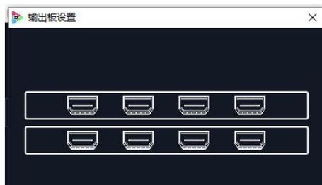
点击其中的输出口，可以对输出口的分辨率进行设置。
