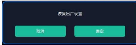
点击“确定”，恢复出厂设置，在矩阵模式下每个输入对应每个输出。输入 1 对应输出 1.
