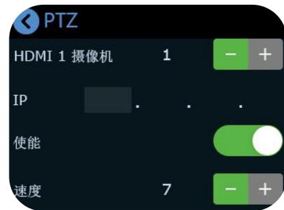
2.打开 PTZ 使能开关,设置摄像机数量并输入相应的 IP 地址(mini-pro 与摄像头需处于同一网段)。您可以通过摇杆调整 PTZ 转速,您也可以直接切换信号源来切换不同的 PTZ 摄像头。
