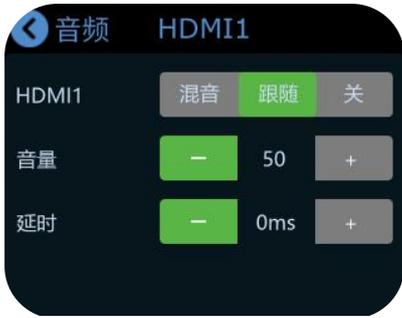
3. 点击【混音】可以将该路输入的音频始终混合到音频主输出；点击【跟随】后，切换视频信号时，音频跟随视频切换能够进行柔和渐变过渡
