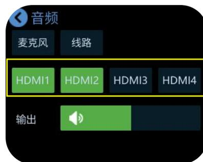
2.mini-pro 的音频支持多个通道同时混合输出。您可以选择打开或者关闭音频输出,也可以通过滑动滑轨调整音量大小,也可以点击【HDMI】【麦克风】【线路】完成更细致的设置
