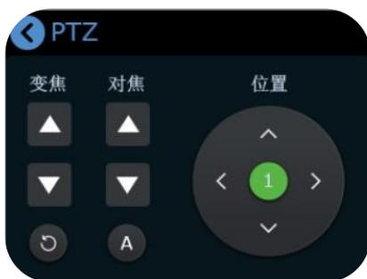
3.您可以调整摄像头的角度和位置。当 PTZ 功能开启后,您可以手动调整摄像头的对焦,也可以轻触 **A**, 实现自动对焦。
