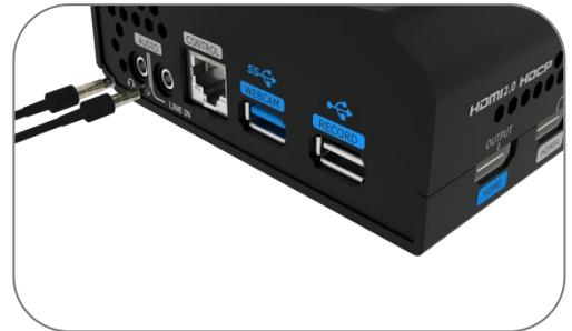
4.mini-pro 具有两路音频输入，用户可连接麦克风至 MIC IN/LINE IN 接口，连接音响或耳机至 AUDIO OUT 接口
