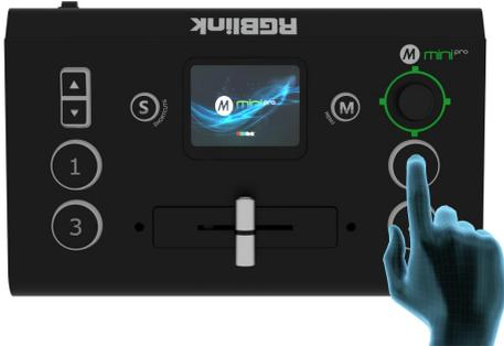
mini-pro 默认是 0.5 秒的淡入淡出直接切换模式，即通过轻按①②③④按键可以直接进行 4 路信号的快速淡入淡出切换
