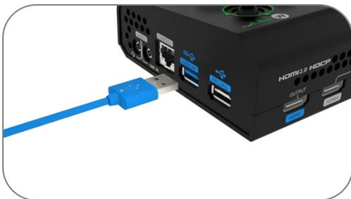
5.通过 USB 线连接 mini-pro 的 USB 3.0 接口与电脑，mini-pro 将被识别为一路网络摄像头信号
