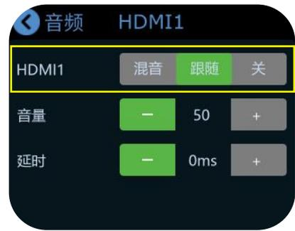
4. 若音视频不同步时，可设置声音的延迟调节。一般情况下，麦克风的延迟会比 HDMI 的画面快约 100ms，所以默认可以调整麦克风的延迟在 80-115ms 之间
