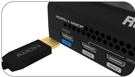
3.通过 HDMI 线将 HDMI OUT 连接到一台带有 HDMI 输入接口的监视器上，可以实时监控输入输出和音频的显示情况
