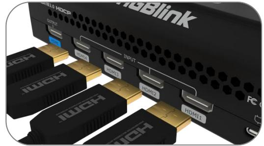
2.通过 HDMI 连接线将电脑、笔记本、摄像机或 DVD 等输入源连接至 mini-pro 的 HDMI IN 接口
