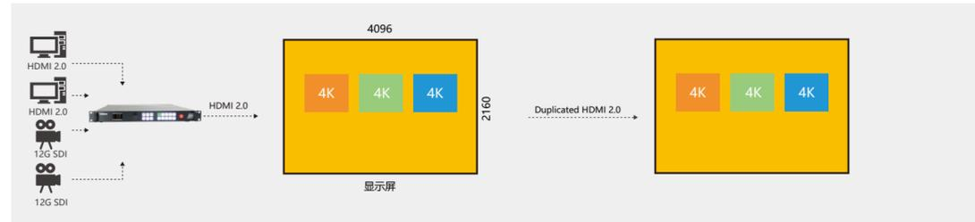
示例：1路HDMI输出主屏4K背景开启3个4K画面，另1路HDMI输出可以做输出备份显示相同的画面
