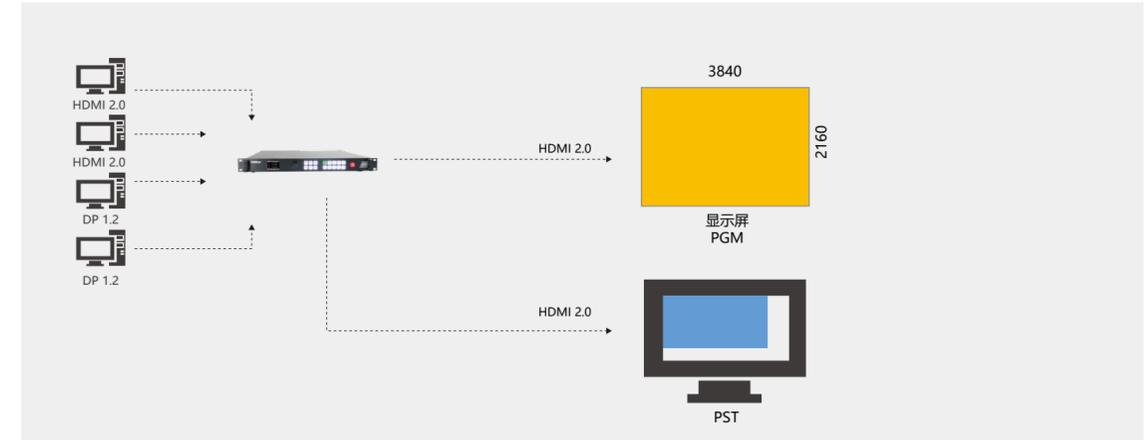
例：通过1路HDMI输出PST (预览) 编辑或缩放后再切换至另1路HDMI输出PGM (主输出)
