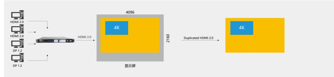
示例：1路HDMI输出主屏4K背景开启4K画面，另1路HDMI输出可以做输出备份显示相同的画面
