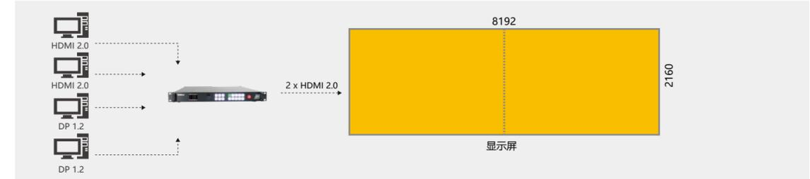
例：4K输入切换为8Kx2K显示，使用两个输出，实现全景或宽屏显示
