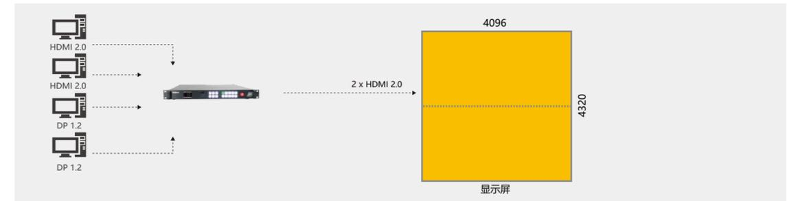
例：4K输入切换为8Kx2K显示，使用两个输出，实现全景或宽屏显示
