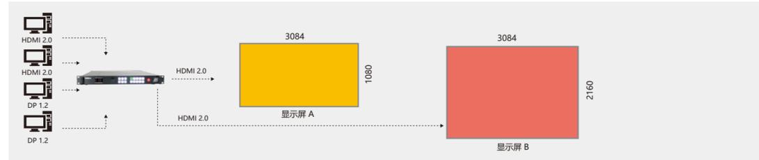
例：两个输入分别对应两个输出，每个输出对应不同分辨率
