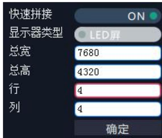
LCD 拼接模式：滑动“显示器类型”开关，选择 LCD 屏，在 LCD 拼接模式中，用户除了对总宽、总高、行和列进行自定义设置外，还可以设置顶边框、底边框、左边框和右边框，如下图所示：
