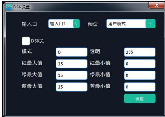
在 DSK 设置中，用户需要在 DSK 开关中打开 DSK 功能，如图：
