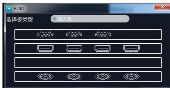
此处为 EDID 信息更改，用于自定义非常规分辨率输出。用户可选择输入板或者输出板，点击任意接口，进行 EDID 读、写及模板设置，设置完成后，点击“**设置**”进行确认，如下图所示：
