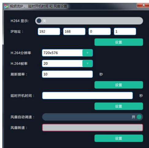
**H264 显示：**用户可以打开或者关闭 H264 显示的功能，选择“开”时，进入操作模式后，界面下方将显示视频信号，主要用于预监。
