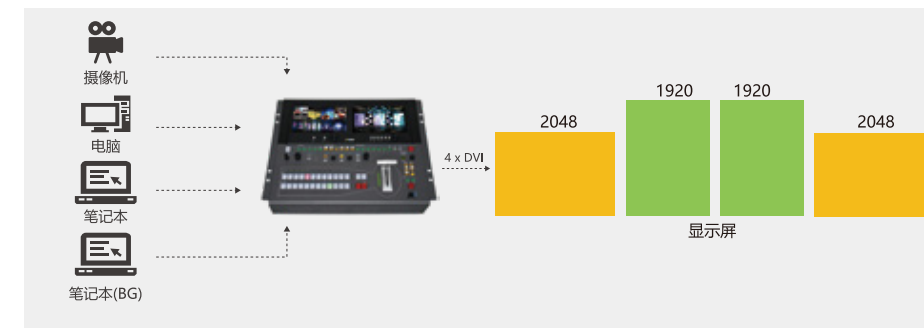
例：多路AUX输出+单独切换设置
