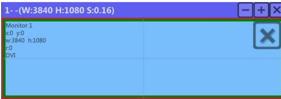
自定义输出分辨率（已创建）：点击模版下方自定义 **自定义** 用户可以根据实际的屏幕大小填入总宽，总高，行，列，系统会根据以上数据自动算出每个输出口对应的宽高。
