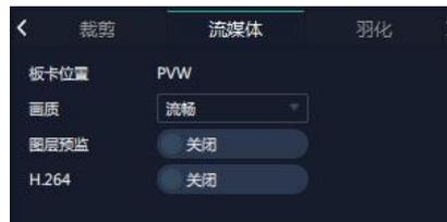
模块位置：显示流媒体 H.264 模块或者 PVW 板所在的位置，Q8 上的 PVW 通过 1 个 HDMI 接口集成在通讯板上，可接扩展显示器直接监看 16 路输入源。
