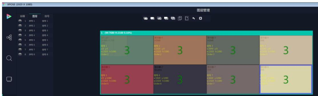
**图层数量**，每个显示器可以放置 4 个图层，每个信号每跨过一个显示器算增加一个图层。输出上数字代表该输出还可以放置的图层数量。
