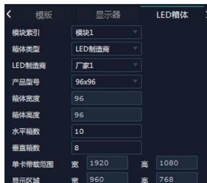
根据发送卡的单卡带载范围设置水平箱体数量和垂直箱体数量。
