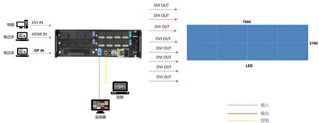
图为 Q8 的系统连接简图
