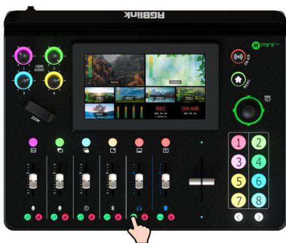
若点击左方的 HDMI 按钮，可对四路 HDMI 在主输出或预监输出通道上的音频实现统一管理，打开则四路 HDMI 在对应通道上全部静音。
