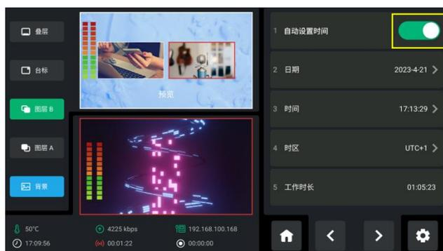
若**设备未连接网络**，用户需要手动进行时间设置，使用 ENTER 按键关闭自动设置开关，设备将保存
