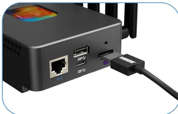
此外，bond 7UHD 的 USB Type-A 接口以及 USB Type-C 接口均支持 UVC(USB Video Class) 输入。您可以将兼容 UVC 协议的设备（例如摄像头）连接到 bond 7UHD 的 USB Type-A 接口或 USB Type-C 接口，以便直接传输摄像头捕捉到的视频信号。
