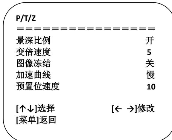
**景深比例：**只对遥控器起作用，开、关；相机变倍拉大后，遥控器控制云台转动速度变慢
