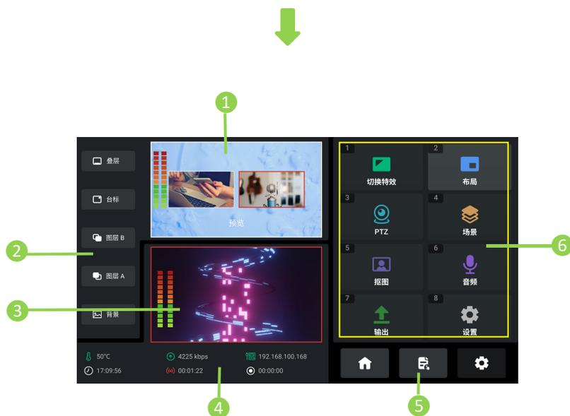
如上图所示， mini-edge SDI 的 5.5 寸全彩显示屏幕的风格和目前手机操作界面相似，一级菜单都是图标按键，通过使用 ENTER 按键进行选择并确认后即可进入相应的功能管理界面。
