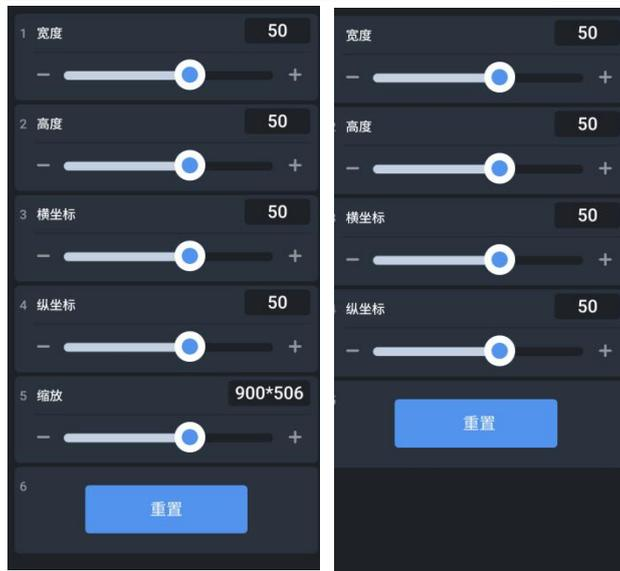
4. 在**图层缩放**设置界面, 旋转 ENTER 按键至某个选项后轻按 ENTER 按键, 用户即可通过旋转 ENTER 按键来调节宽度, 高度, 横坐标, 纵坐标以及缩放比例等参数。与图层缩放设置一样, 在**图层裁剪**设置界面, 可通过旋转 ENTER 按键来调整图层宽度, 高度, 横坐标以及纵坐标。若设置错误, 旋转 ENTER 按键至**重置**, 轻按按键即可选择是否恢复至默认值。
