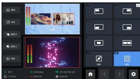
3. mini-edge SDI 支持设置图层缩放和裁剪的具体参数。使用 ENTER 按键进入【7】缩放界面或【8】裁剪界面, 如下图所示。
