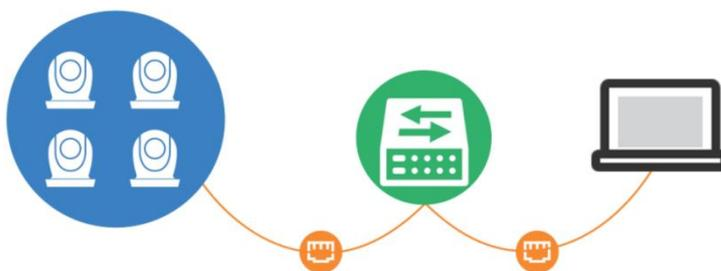
3.2.4 将 mini-edge SDI 和需要控制的摄像机通过网线（推荐使用 RGBlink CAT6 网线，销售编码为：940-0001-00-11-0）连接到上述测试过的交换机上，mini-edge SDI 便可控制这几台摄像机。
