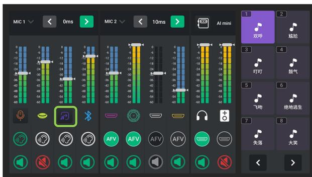
2. 使用界面的 "+" 和 "-" 即可升高或降低相应输入信号源的音频电平。
