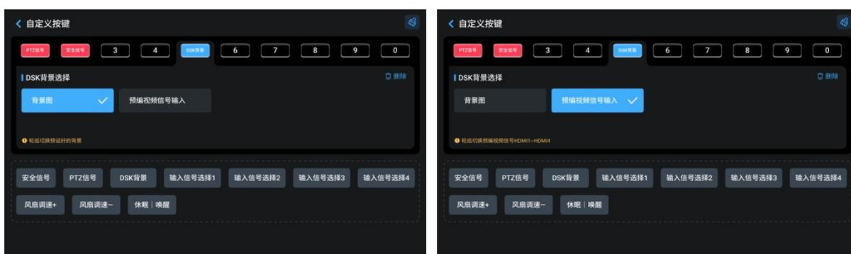
● 背景图：选择预设好的背景作为抠图的背景信号。连续按已分配该功能的按键即可切换至下一张已储存到设备的背景图；若已切换至最后一张背景图，再次按该按键将切换至第一张背景图。
