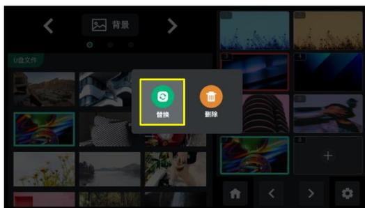
2.3 选中“替换”后，光标将会自动跳转至界面左侧的素材选择区，绿色边框代表光标所处位置。旋转 ENTER 按键选择好需要替换的素材后，轻按 ENTER 按键，将该素材替换至选中窗口中的素材。
