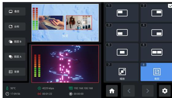
5. mini-edge SDI 支持设置图层缩放和裁剪的具体参数。旋转 ENTER 按键至缩放/裁剪选项后轻按 ENTER 按键即可进入选项对应的参数设置界面。使用 ENTER 按键选中需要调整的选项后旋转 ENTER 按键即可调节参数。
