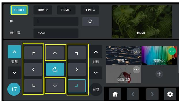
3. 转速调整：用户可设置摄像机的转速为 17，14，11，8，5，2，默认转速为 17。如下图所示，界面左下角显示的数字为摄像机的转速，使用 ENTER 键旋转至转速调整位置后轻按 ENTER 调整转速。
