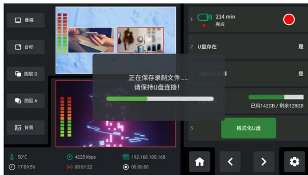
2. U 盘支持的格式为 exFAT，若格式不符合，将 U 盘进行格式化：在 Windows 电脑上将文件系统设置为“exFAT”，将分配单元大小设置成 128kb > 使用 ENTER 按键选择格式化 U 盘 > 确认。
