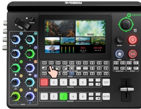
用户也可以轻按【MENU】键进入菜单界面，旋转 ENTER 按键至“布局”后轻按 ENTER 按键进入布局选择界面。旋转 ENTER 按键至所需布局后，轻按 ENTER 键确认。布局选择完成后，图层 A 将按照该布局在背景上显示。
