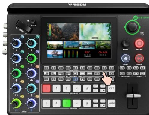
2. 您可以选择在 PVW 预览窗口预览信号源或者直接将信号源添加至 PGM 主输出窗口。PGM 行数字键 1~5 用于选择 PGM 的信号源。选定的 PGM 红灯常亮表示主输出状态。PVW 行数字键 1~5 用于选择预览的信号源。选定的 PVW 绿灯常亮表示预览输出状态。
