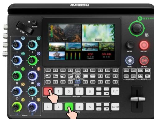
3. 选择完图层 A 后，若处于主界面，用户可以通过前面板的调焦器对预览窗口的图层进行缩放，通过五向摇杆调整图层的水平位置和垂直位置。
