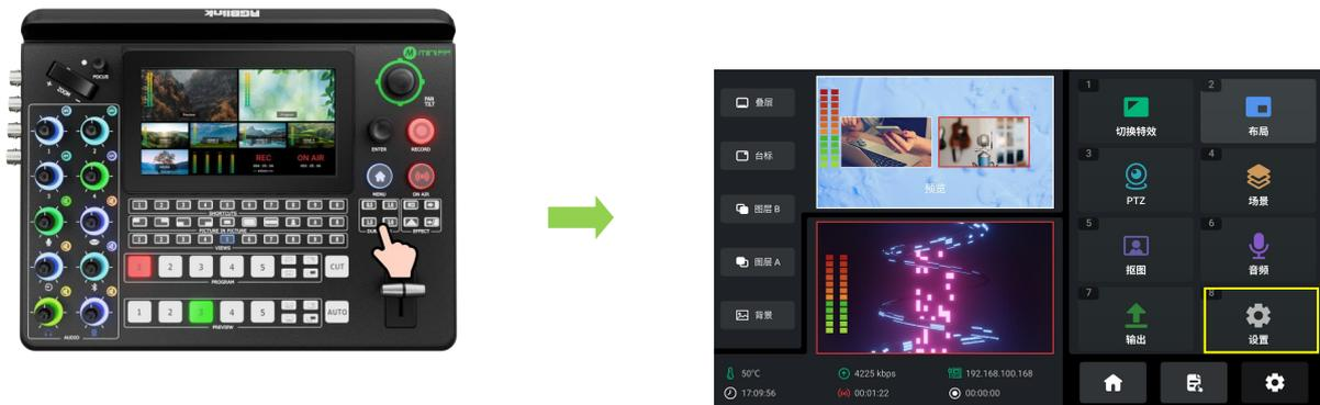
2. 如下图所示，设置菜单包括 15 个部分的功能：**关于，日期和时间，输入，语言，网络，蓝牙，场景轮巡，切换模式，风扇，显示，色彩管理，主输出摄像头保护，T-Bar 校准，自动返回，工厂复位。**
