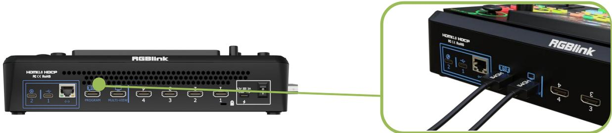
多画面输出口 (MULTI-VIEW)可连接监视器, 默认输出多画面。主输出口(PROGRAM)可连接投影仪、LED 屏幕、电视机等设备。
