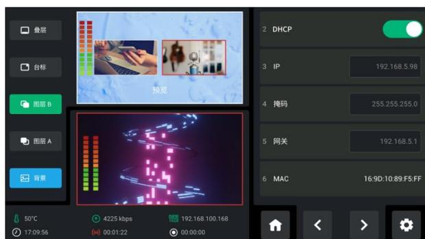
2. 用户手动设置 IP 地址。关闭 DHCP 开关，使用 ENTER 旋钮选中 IP 地址行，前面板的 SHORTCUT 行亮起为蓝色，按键为数字功能，以供用户修改 IP 地址。
