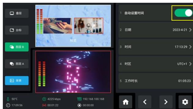
2. 若**设备未连接网络**，用户需要手动进行时间设置，使用 ENTER 按键关闭自动设置开关，设备将保存设定时间并开始自动计算。
