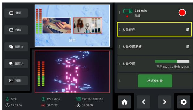
4. 确认无误后，轻触面板上【RECORD】录制键开始录制，前面板的录制键从白色变为红色，代表录制开启。录制过程中在录制菜单页，主菜单和多画面显示屏界面分别可查看录制的动态和时间。
