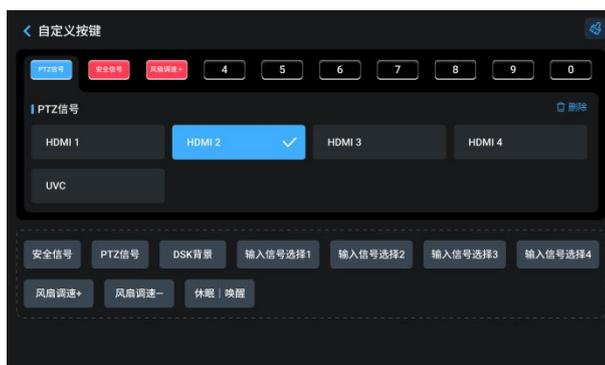
选择 HDMI 信号或 UVC 信号即可打开该信号对应的 PTZ 控制界面，该 PTZ 的使能开关亦同步开启。
