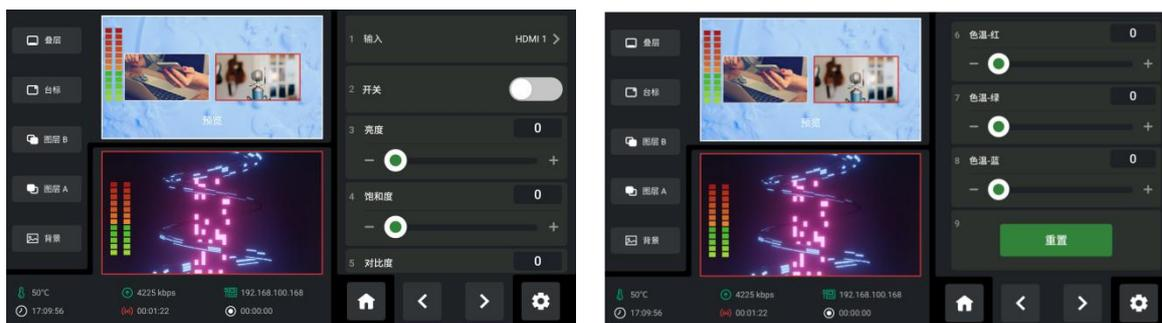
2. 色彩管理开关默认关闭。打开开关，您可以对 4 路 HDMI/SDI 输入源的各项色彩显示相关项进行设置与调整，包括亮度，饱和度，对比度以及色温值。
