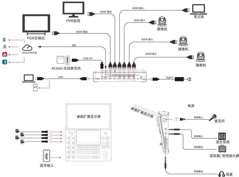
mini-edge SID 的前面板最上方设有卡槽，可便捷插入视诚桌面拓展显示屏，瞬间拓宽用户的监视视野。该显示屏配备全功能 Type-C 接口，集供电与音视频信号传输功能于一身，高效又实用。其 mini HDMI 接口兼容性强，能轻松适配高清电视、高清摄像机等众多设备，满足多样化使用需求。
