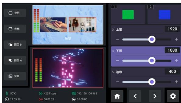
3. 当选定一个抠图颜色后，前面板的抠图按键亮起为绿色，图层 B 按键亮起为蓝色，预览画面自动跳转呈现图层 B 抠掉对应颜色的画面。用户也可以通过轻按前面板 PICTURE IN PICTURE 行的
