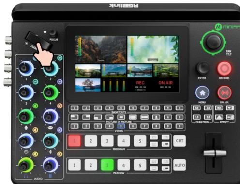
1.2 轻按前面板的聚焦旋钮可实现自动对焦。旋转该旋钮可实现手动对焦。
