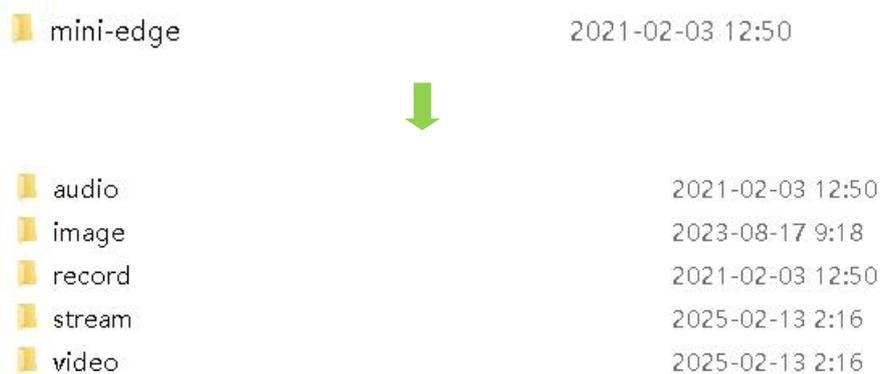
2. 在 U 盘对应的文件夹内导入需要添加的素材后，将 U 盘插入 mini-edge SDI 的 USB 接口 1。
