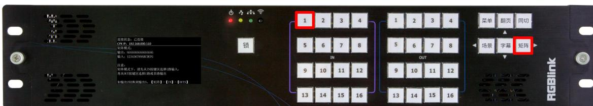
操作步骤 3：依次按【OUT 7】，【OUT 8】，输出口 7、8 按键灯亮。此时输入 1 信号变成功切换到输出口 7 和输出口 8，CPX 液晶屏上输入和输出的匹配关系会同步切换。
