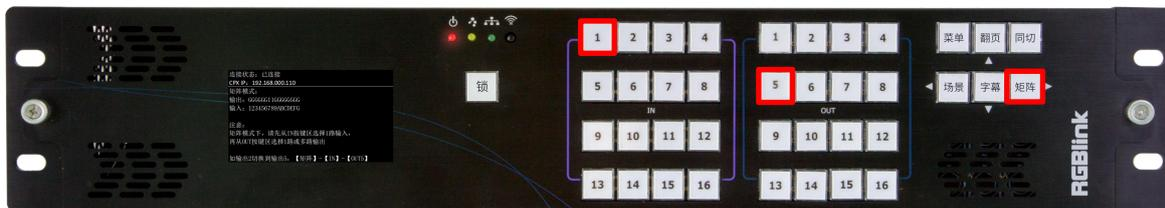
操作步骤 2：在操作步骤 1 选中【IN 1】后，【OUT 5】按键灯亮。现在需要取消第 5 路输出，按【OUT 5】，【OUT 5】即输出 5 按键灯灭；输出 5 端口所连的屏幕随之变为空信号。
