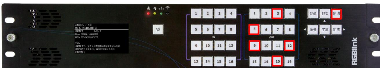
操作步骤 3：按输入 1【IN 1】，输入 1 按键灯亮，此时用户便将【IN 1】信号给到所选中的所有同切输出组。
