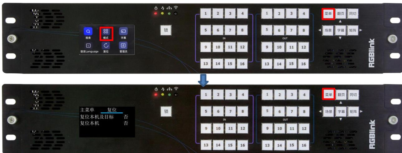
**复位本机及目标：**同时复位 CPX 及连接的控制设备信息，如 Q2。
