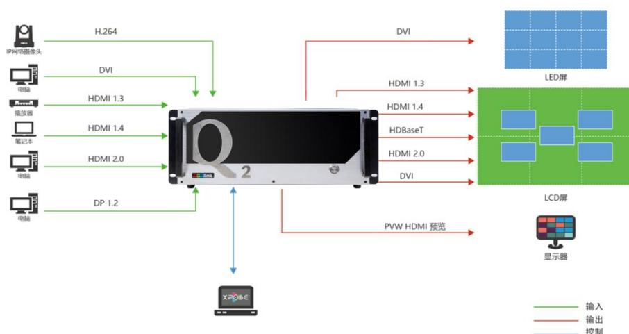
Q2 Gen2 系列支持 HDMI, SDI, DP 1.2, HDMI 2.0 等接口的输入和输出。请使用相应的线材将其输入源，例如摄像头、电脑、笔记本等设备接入设备的输入口；请使用相应线材连接输出口与显示屏。
