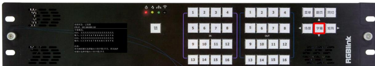
进入字幕切换模式时需要检测矩阵现在的字幕状态，调用相应字幕的输出端口所对应的按键灯亮。
