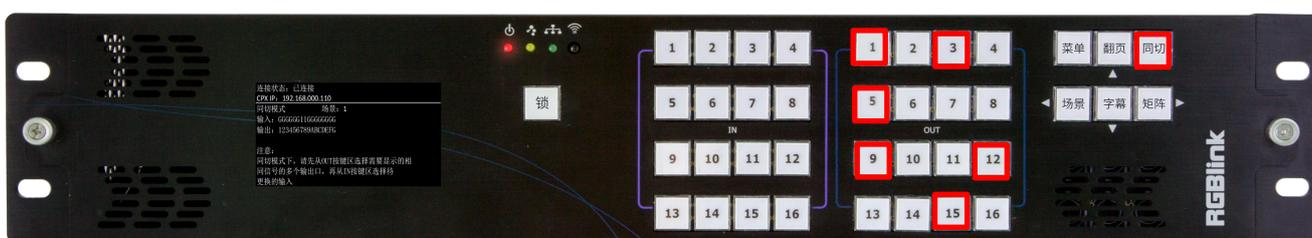
操作步骤 2：按输出 1【OUT 1】，输出口 1 按键灯灭，此时用户便将【OUT 1】移出同切输出组（假设输出 1，3，5 同切分组原先显示信号 8 画面，移出同切分组后，输出口 1 继续显示信号 8 画面。）
