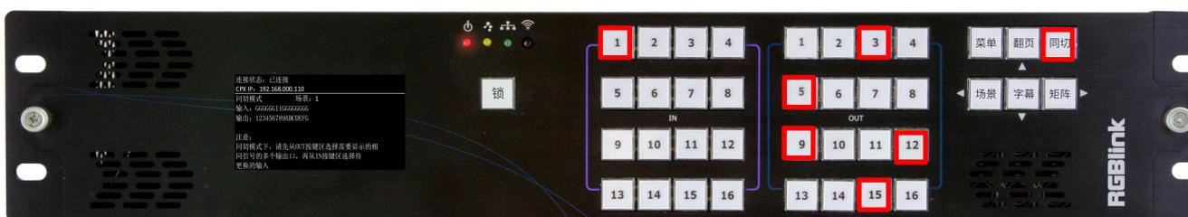
操作步骤 4：按输入 5【IN 5】，输入 5 按键灯亮，此时用户便成功将所有同切输出组的信号由输入 1 信号切换到输入 5 信号。
