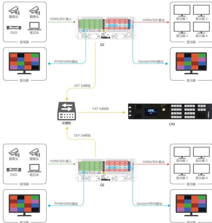
Q2 支持 HDMI、SDI 接口的输入和输出。请使用相应的线材将其输入源，例如摄像头、电脑、笔记本等设备接入设备的输入口；请使用相应线材连接输出口与显示屏。连接完 Q2 的输入源和输出源以后，用户需将 Q2 与 CPX 上电（将 CPX 标配 12V 电源适配器的一头接入设备的电源接口，另一头插入插座，并将插座的电源打开）。为了实现 CPX 对 Q2 的控制，用户需要在 CPX 上先选择设备类型：Q2。
