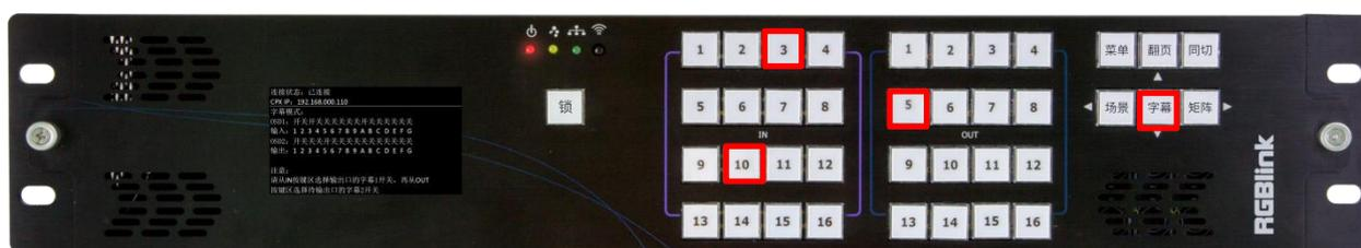
操作步骤 2：按下【OUT 12】键，【OUT 12】按键灯亮，此时便将字幕 2 的内容调用到输出 12 口上显示。
