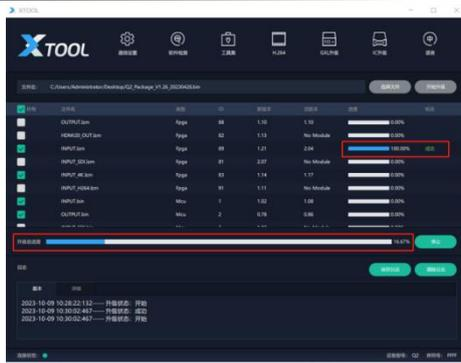
7. 程序升级完成后，弹出“新版本升级完成”提示对话框，点击“确定”。升级成功后，请断电重启设备。
