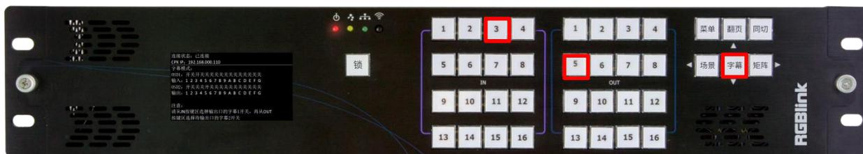
例：若用户需要在输出 10 口上调用字幕 1，在输出 12 口上调用字幕 2，可按照以下步骤进行操作。
