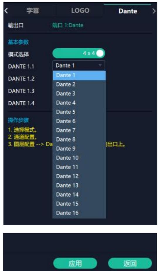
完成以上设置后，点击**应用**即可保存。后续您便可以在**图层配置**中对 Dante 音频进行更详细的设置。
