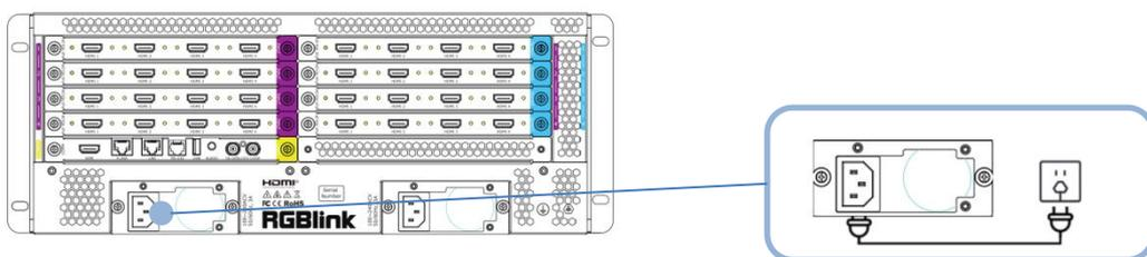
请使用标配的电源线连接电源与 Q2 Gen2 设备。
