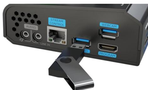
将 U 盘插到 mini-ISO 带有 RECORD 标识的 USB 录制接口上面。使用录制功能前请先将您的 U 盘进行格式化。在 mini-ISO 上格式化 U 盘步骤如下：
