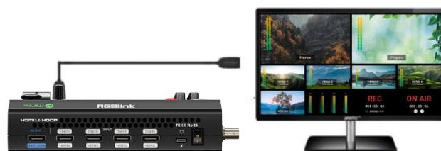
HDMI 多画面输出除了支持多画面监看外, 还支持选择固定输出某一路输入信号或者直接选择主输出的信号, 您可以通过菜单里面的输出设置进行 PVW 和 PGM 的切换与各个输入信号之间的切换。
