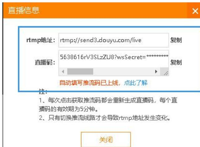
(3) 回到 OBS，在左侧流设置中对于中文直播平台，流类型设置为自定义，在服务器和流名称中分别粘贴直播平台提供的 rtmp 和直播码；
