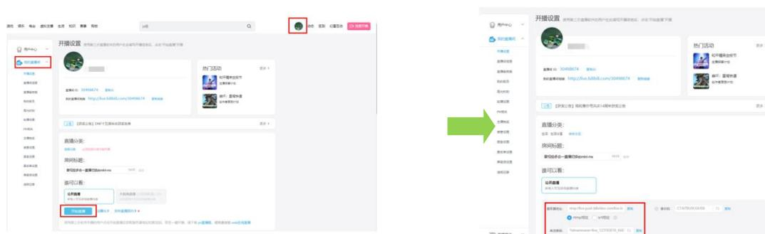
2. 将推流地址和密钥复制到 TAO 云平台上，点击“下发”。而后在设备前面板上按下“ON AIR”实现推流。mini-ISO 最多支持 4 个平台同时进行推流。用户也可以打开推流界面或快捷界面的推流开关开启推流。在推流过程中，用户可以中途打开或关闭其中任一流地址来打开或关闭某一平台的推流。
