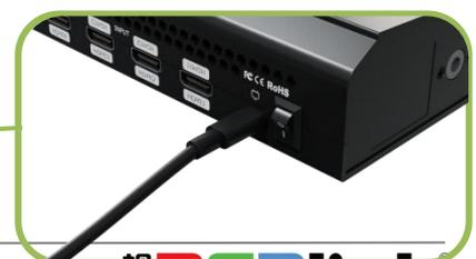
通过提供的电源连接线连接 mini-ISO 与电源
