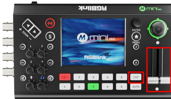
如果您想使用更多的切换效果，可以通过轻触触摸屏的【切换特效】进入切换过渡效果的选择，包括淡入淡出以及其他各种拉幕切换效果。
