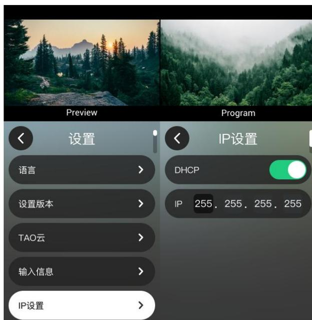
静态：若不使用 DHCP 分配 IP 功能，用户可以手动设置静态 IP。关闭 DHCP 开关，用户可手动设置 IP 地址。
