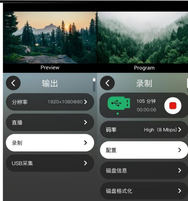
在录制过程中，主界面上的“REC”框会有一个红色边框，并显示录制的总时长。
