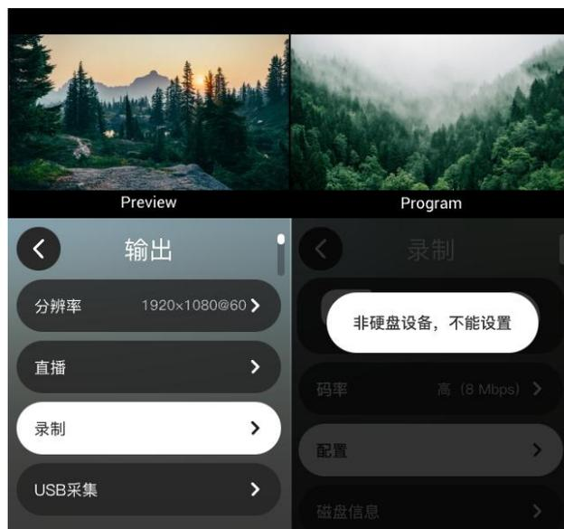
插入 U 盘后, 先将 U 盘进行格式化: 在 Windows 电脑上将文件系统设置为“exFAT”, 将分配单元大小设置成 128kb > 点击“磁盘格式化” > “是”, 即可完成磁盘格式化操作。
