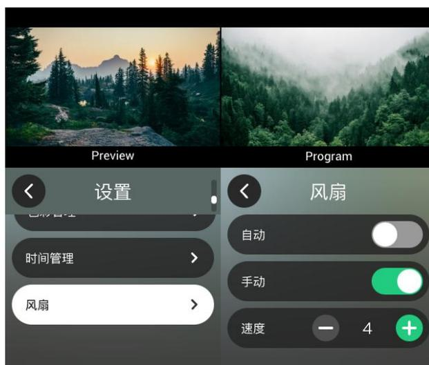
打开自动，设备便会自动调整风扇转速。关闭自动，便可手动调整风扇转速，转速支持四档可调。
