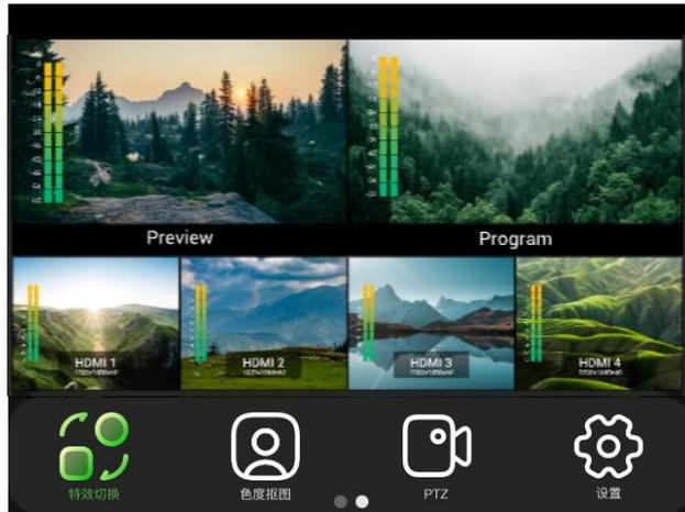
mini-ISO 支持 CUT 快切和 AUTO 模式。如若在前面板按下“CUT”快切键，设备为快切，没有切换特效。如下图所示：
