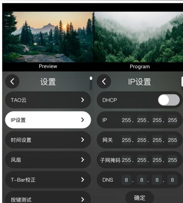
打开 DHCP 开关，设备可自动获取 IP 地址，关闭 DHCP 开关可手动配置 IP 地址，子网掩码和网关。
