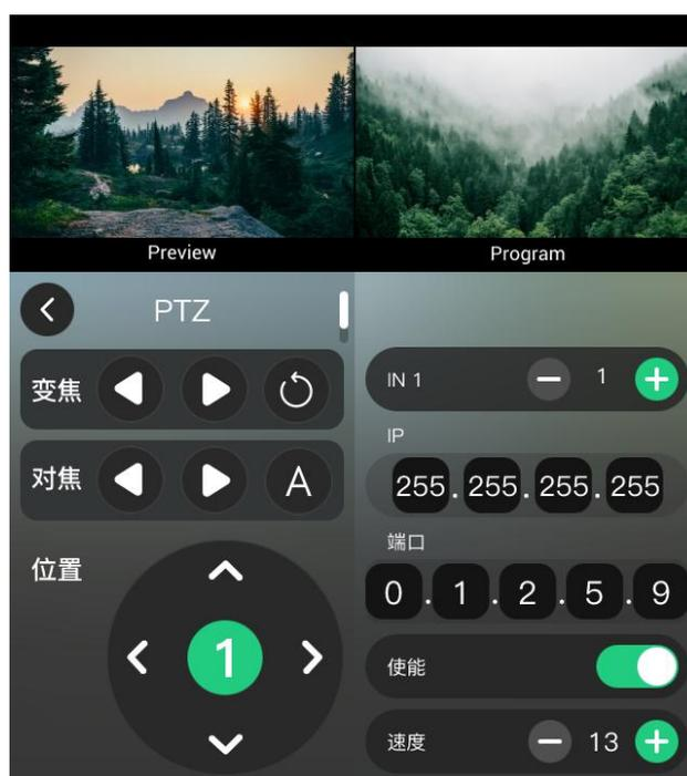
控制 PTZ 时，mini-ISO 与摄像头需处于同一网段，您可在【PTZ】菜单中，通过 ENTER 旋鈕或触屏定位光标，修改 mini-ISO 的 IP 和端口数值。
