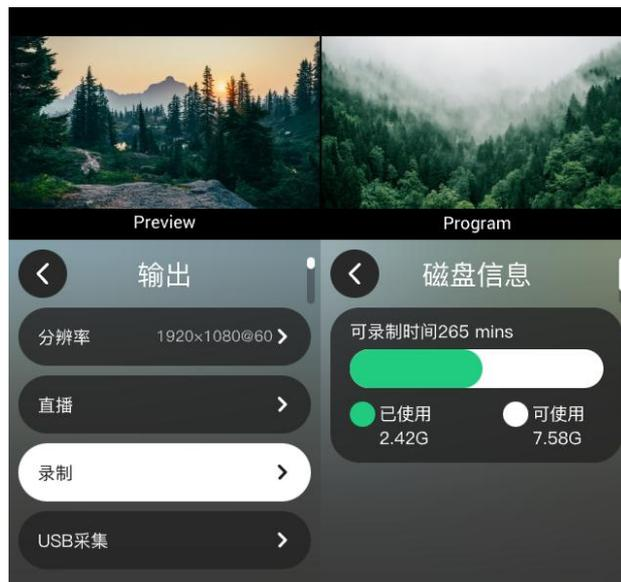
点击该界面的录制开关，或预设调用菜单界面的录制图标，mini-ISO 便会开始录制。在录制界面，您可以查看录制总时长以及录制进度。
