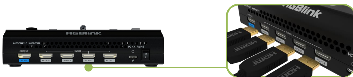
通过 HDMI 连接线将电脑、笔记本、摄像机或 DVD 等输入源连接至 mini-pro 的 HDMI IN 接口
