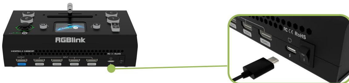
通过提供的电源连接线连接 mini-pro 与电源
